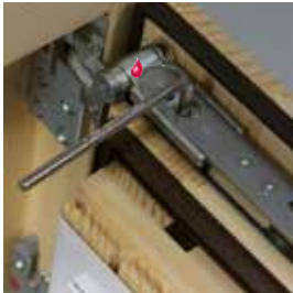
Seitenverstellung oben + / - 2 mm
