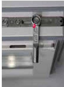
Sicherheits-Pilzzapfen Flügelandruckeinstellung (SW 11) + / - 1 mm
