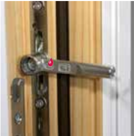
Sicherheits-Pilzzapfen Flügelandruckeinstellung (SW 11) + / - 1 mm
