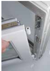
2. Eckband in Bandlager einführen (gleiche Position wie beim Einhängen)
