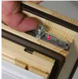
Sicherheits-Pilzzapfen Automatische Höheneinstellung zum Falzluftausgleich bzw. durch Handeinstellung + 2,5 mm
