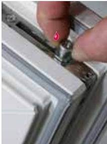
Sicherheits-Pilzzapfen Automatische Höhen- einstellung zum Falz- luftausgleich bzw. durch Handeinstellung + 2,5 mm
